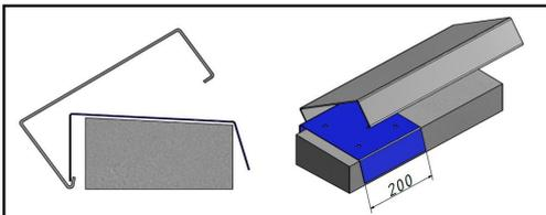
Variante 1: Halblech ohne Gefälleausbildung d.h. Gefälle wird durch Unterkonstruktion realisiert
